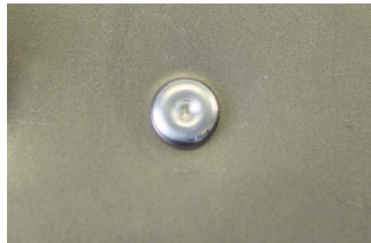
ERGEBNIS DER APPLIKATION EINES FLIESSFORMNIETES
