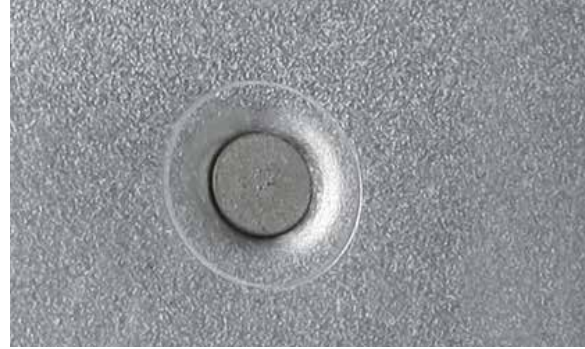
RESULTADO AL PONER UN REMACHE AUTOPERFORANTE
