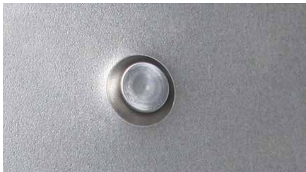
RISULTATO DELLA POSA DI UN RIVETTO AUTO-PERFORANTE
