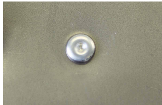
RESULTAAT VAN EEN FLOW FORM PONSNAGELVERBINDING.
