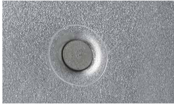
AFBEELDING PONSNAGEL VERBINDING VOOR- EN ACHTER-ZIJDE
