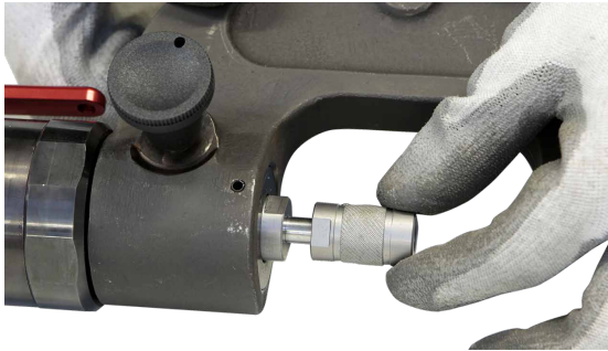
Schrauben Sie den Verlängerungsadapter an den Arm.
