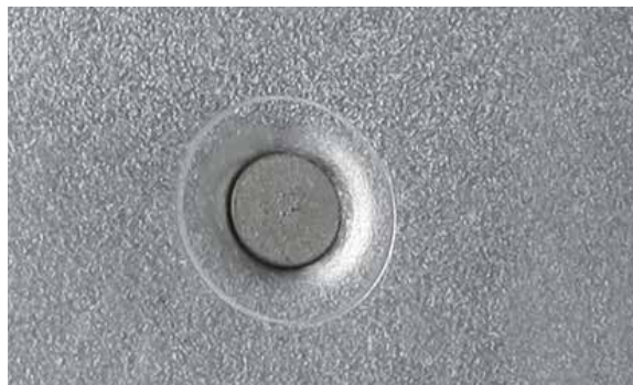
RISULTATO DELLA POSA DI UN RIVETTO AUTO-PERFORANTE
