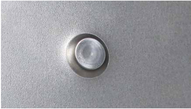
ABBILDUNG STANZNIETVERBINDUNG VORDER- U. RÜCKSEITE
