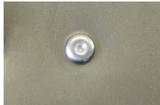
RESULTADO AL PONER UN REMACHE FLOW-FORM
