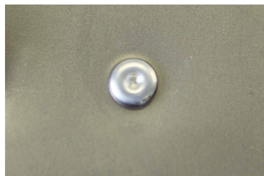
РЕЗУЛЬТАТ УСТАНОВКИ ЗАКЛЕПКИ ТЕКУЩЕЙ ФОРМЫ FLOW-FORM
