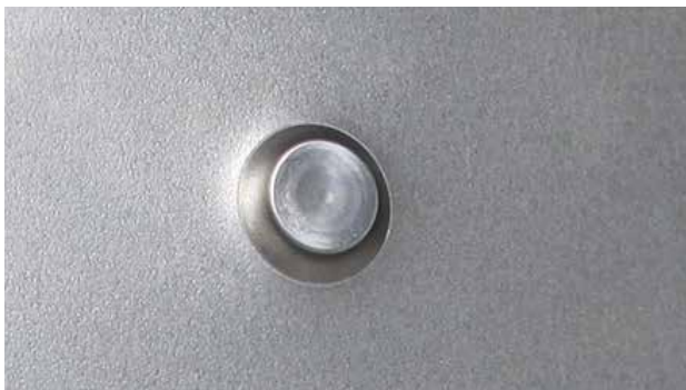
RÉSULTAT DE POSE D'UN RIVET AUTO-PERÇANT
