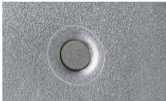
РЕЗУЛЬТАТ УСТАНОВКИ САМОПРОНИКАЮЩЕЙ ЗАКЛЕПКИ
