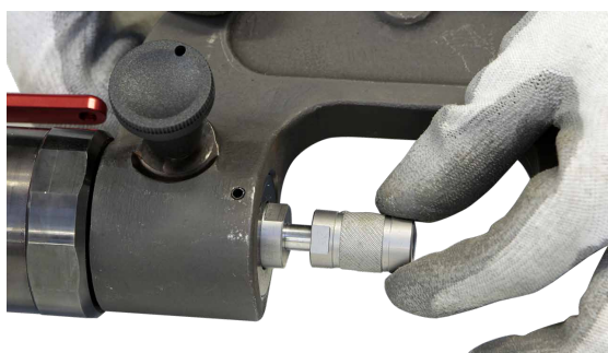
Привинтите насадку, идущую в комплекте с плечом.
