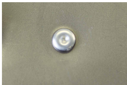
RÉSULTAT DE POSE D'UN RIVET FLOW-FORM
