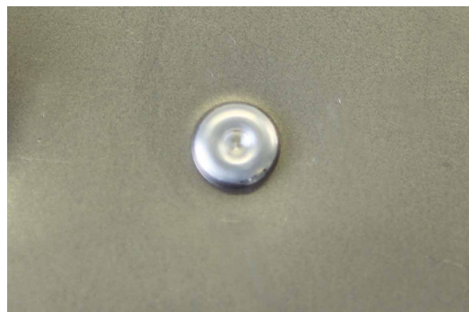
RISULTATO DELLA POSA DI UN RIVETTO FLOW-FORM
